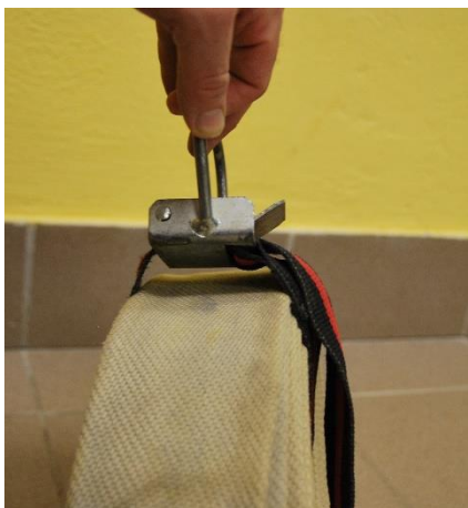
PRAVILNO ZAPET CEVNI NOSILEC
