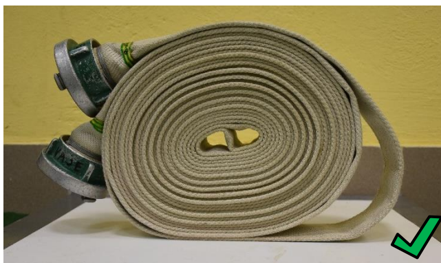
Slika 9: Pravilno zvita C-cev z dovoljeno ohlapnostjo.
