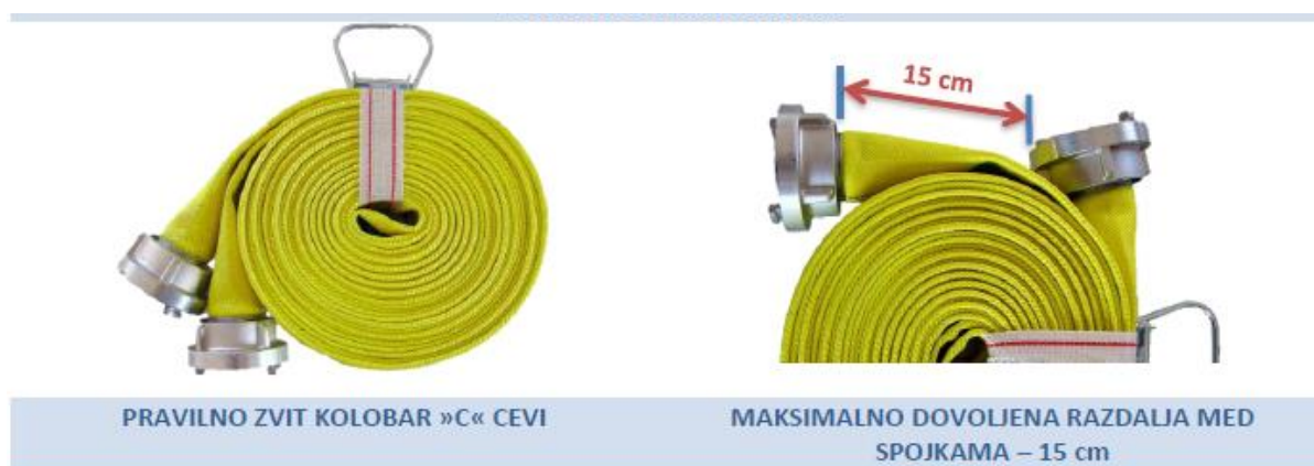
Slika 5: Pravilno zvitá C-cev in maksimalno dovoljena razdalja med spojkama (15 cm).
