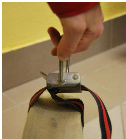
NEPRAVILNO ZAPET CEVNI NOSILEC
